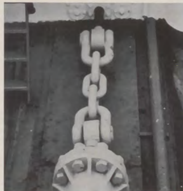
An dieser Feder hängt die Kette, 250 Meter lang, mit einem riesigen Pilzanker.
