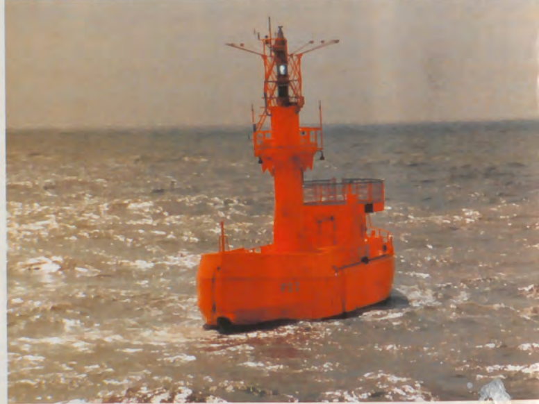
Jetzt liegt dieses unbemannte »Computer-Feuerschiff« vor der Elbmündung. Es wird aus der Ferne elektronisch überwacht.
