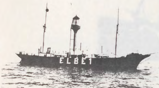
Das am 27. Oktober 1936 im Orkan gekenterte Feuerschiff. Bauwerft: Nüske & Co., Stettin, Baujahr: 1911/12, Länge: 49,00 m, Breite: 7,70 m. Auf Station: 3. Mai 1912. Es war das erste mit einem elektrischen Feuer ausgestattete Feuerschiff Deutschlands. Name: 'Bürgermeister O'Swald'.
